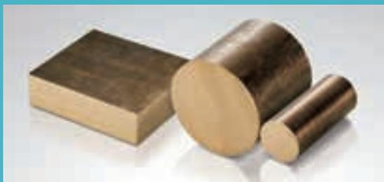
アルミニウム青銅は強度が高く、耐摩耗性・耐腐食性・耐被労性に優れています。また、バネ性が強く非磁性強力材です。用途は車両用、機械用、船舶用などに使われております。
