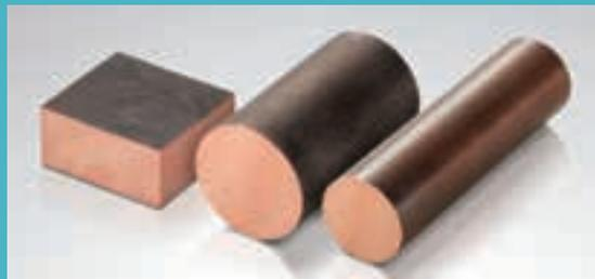
銅(Cu)残、ベリリウム(Be)0.2~0.4%、銀(Ag)0.1~0.3%を含むものです。特性としては、高強度、導電率約50%電極用に優れており、電極チップに使われております。
