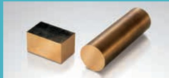
銅(Cu)残、ベリリウム(Be)1.8~2.0%などを含むものです。特性として、高強度、導電率約25%機械用に優れており、溶接用部品、スイッチなどに使われております。
