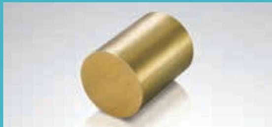
銅(Cu)56.0～60.5%の黄銅にアルミニウム(Al)2.0%以下、マンガン(Mn)2.5%以下、鉄(Fe)1.0%以下を添加した合金(C6782)です。黄銅に高強度をもたせたもので、船舶用プロペラ軸、ポンプ軸などに使われております。
