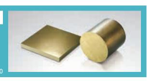
銅(Cu)59.0~64.0%、すず(Sn)0.50~1.5%、残り亜鉛(Zn)からなる合金(C4621・C4641)。強度と耐海水性に優れています。 管板、その他海洋構造材などに使われております。
