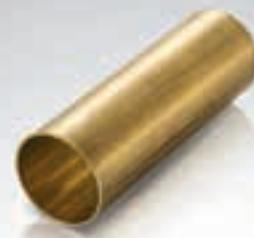
銅(Cu)63~67%、亜鉛(Zn)約35%配合で、押し広げ性・曲げ性・めっき性・深絞り加工性に優れています。カメラ・カーテンレール・衛生管などに使用されております。
