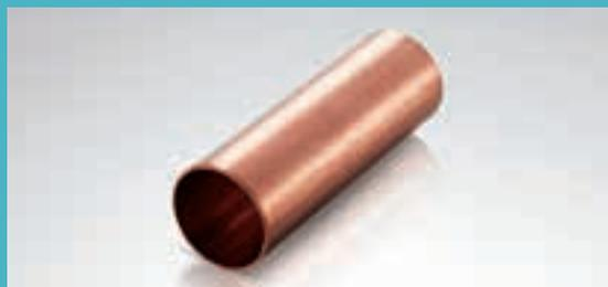
銅(Cu)99.90%以上、りん(P)0.015~0.040%を含む純銅。酸素量が少ないので水素脆化もなく、耐食性、耐候性、絞り加工性、熱伝導性(熱伝導率80%前後→りん(P)が伝導性を妨げる)に優れています。風呂釜、屋根板などに使用されています。
