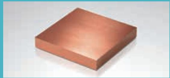
銅(Cu)99.96%以上含む純銅で、電気・熱の伝導性、ろう付け性・深絞り性に優れ、溶接性・耐食性・耐候性が良い。含有酸素量が0.001%以下なので水素脆化を起こす恐れがなく、電気用、化学工業用などに使われております。
