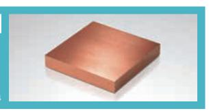
銅(Cu)99.96%以上含む純銅で、電気・熱の伝導性、ろう付け性・深絞り性に優れ、溶接性・耐食性・耐候性が良い。 含有酸素量が0.001%以下なので水素脆化を起こす恐れがなく、電気用、化学工業用などに使われております。
