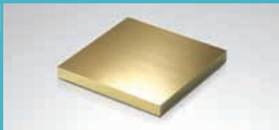
銅(Cu)59~62%、亜鉛(Zn)約40%の配合で、熱間加工が容易で鍛造用に適し、引張強度が高く、展延性があります。黄銅の性質として銅分が57%未満になると硬くて、脆くなるため鋳物として使われております。用途は、打ち抜いたまま又は折り曲げて使用する配線器具部品、ネームプレート、計器板、溶接棒などです。
