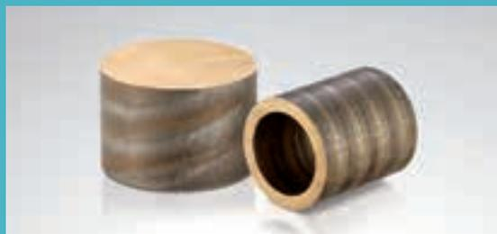
銅(Cu)83.0～87.0%、鉛(Pb)4.0～6.0%、すず(Sn)4.0～6.0%、亜鉛(Zn)4.0～6.0%を含むものです。砲金は、1～7種まであり、鑄造方法は、連続鑄造です。用途としては、耐圧性、耐磨耗性、被削性が良く、例えば、一般バルブコック類、軸受、スリーブ、ブッシュその他機械部品に使われております。
