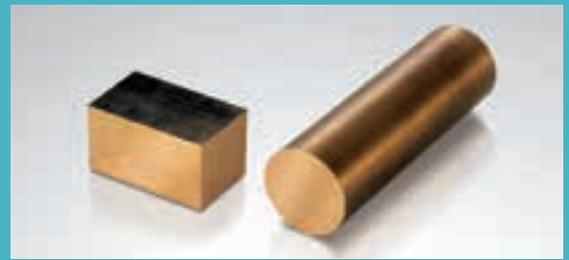
銅(Cu)残、ベリリウム(Be)1.8~2.0%などを含むものです。特性として、高強度、導電率約25%機械用に優れており、溶接用部品、スイッチなどに使われております。
