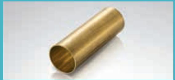
銅(Cu)63～67%、亜鉛(Zn)約35%配合で、押し広げ性・曲げ性・めっき性・深絞り加工性に優れています。カメラ・カーテンレール・衛生管などに使用されております。
