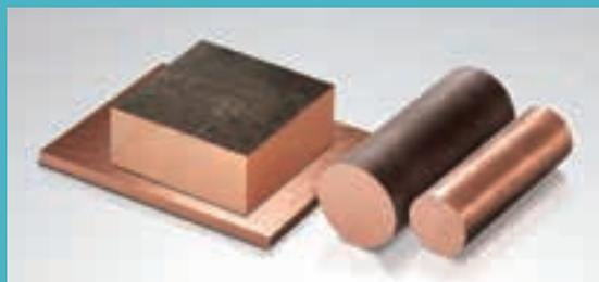
銅(Cu)残、クロム(Cr)0.7~1.4%の配合で、焼入れ・焼戻しによる析出硬化型の合金である。最高使用温度は420℃までで高温においても耐摩耗性が大きい。この合金は、電気抵抗溶接機用電極材のほか、自動車、歯車、軸受などに使われております。
