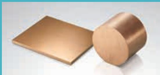
C5191は銅(Cu)残、すず(Sn)5.5～7.0%、りん(P)0.03～0.35%が含まれ、3つを足して99.50%以上のものをいいます。りん青銅は、1～3種まであり、機械的な強さが大きく、耐疲労性、耐食性、耐磨耗性に優れ、鉄鋼のような磁性がありません。ねじ、軸受、ボルト、コネクタなどに使われております。
