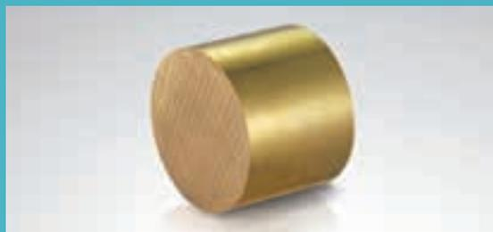
銅(Cu)57～61%、鉛(Pb)1.8～3.7%、鉄(Fe)0.50%以下の配合で、特性として被削性に優れています。ボルト、ナット、歯車、ライター、時計に使われております。
