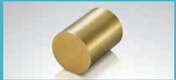
銅(Cu)56.0～60.5%の黄銅にアルミニウム(Al)2.0%以下、マンガン(Mn)2.5%以下、鉄(Fe)1.0%以下を添加した合金(C6782)です。黄銅に高強度をもたせたもので、船舶用プロペラ軸、ポンプ軸などに使われております。
