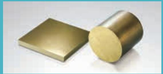
銅(Cu)59.0～64.0%、すず(Sn)0.50～1.5%、残り亜鉛(Zn)からなる合金(C4621・C4641)。強度と耐海水性に優れています。管板、その他海洋構造材などに使われております。
