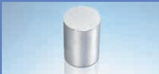
板材であるA5052Pと同様にAl-Mg系合金の中強度の強度を持つ合金丸棒です。特に耐食性、成形加工性、溶接性に優れ、引張強度のわりに疲労強度が高いので多方面に応用されています。
