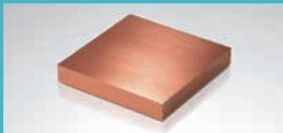
銅(Cu)99.96%以上含む純銅で、電気・熱の伝導性、ろう付け性・深絞り性に優れ、溶接性・耐食性・耐候性が良い。含有酸素量が0.001%以下なので水素脆化を起こす恐れがなく、電気用、化学工業用などに使われております。
