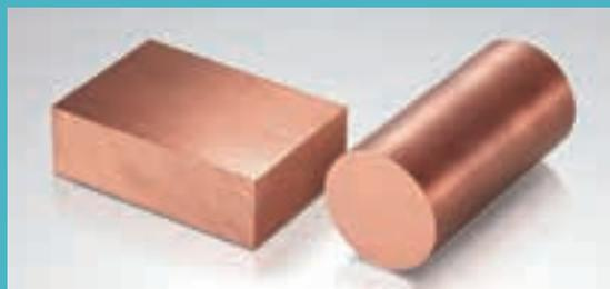
銅(Cu)にテルル(Te)を0.4～0.6%添加した高銅合金です。被削性に優れ、放電加工用電極、トーチ火口(ひぐち)などの切削加工材に使われております。
