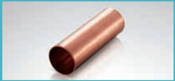
銅(Cu)99.90%以上、りん(P)0.015~0.040%を含む純銅。酸素量が少ないので水素脆化もなく、耐食性、耐候性、絞り加工性、熱伝導性(熱伝導率80%前後→りん(P)が伝導性を妨げる)に優れています。風呂釜、屋根板などに使用されております。
